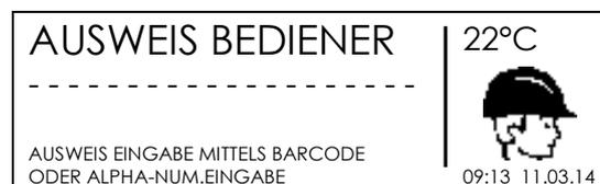
Die Eingabe erfolgt entweder durch Einlesen eines Barcodes (interleaved 2/5) oder manuell (20 Zeichen).
