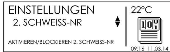
Wählen Sie mit den Pfeiltasten den aktivieren / deaktivieren aus und bestätigen Sie die Auswahl mit START/OK (I) Taste, mit STOP/ESC (O) verlassen Sie das Menü.
