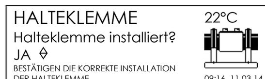
Wenn die "Halteklemme" Warnung gezeigt wird, erscheint im Bildschirm die Abfrage ob die Halteklemme richtig installiert bzw. verwendet wird. Mit Hilfe der Tasten ↑ und ↓ wird JA oder NEIN ausgewählt und mit der Start/OK Taste bestätigt.
