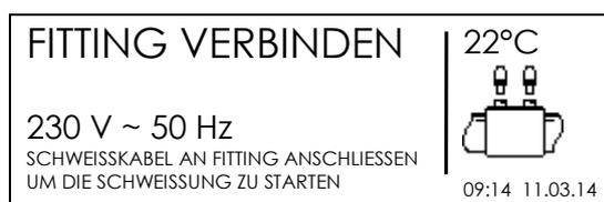
Zusätzlich zur Aufforderung den Fitting anzuschliessen werden verschiedene Werte angezeigt: Umgebungstemperatur, Datum und Zeit, Eingangsspannung und Frequenz .
