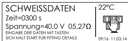
Mit Hilfe der Tasten (▲)(▼) wird die Spannung ausgewählt und mit START/OK (I) bestätigt, automatisch wechselt man zu der Schweisszeit. Geben Sie mit den Tasten (▲)(▼) und (◀)(▶) die Schweisszeit in Sekunden ein. Die Eingabe wieder mit START/OK (I) bestätigen.
