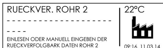
Die Barcode werden einer nach dem anderen eingelesen, das Display wechselt automatisch von einer Komponente zur anderen. Falls die Funktion als optional konfiguriert wurde und kein Barcode vorhanden ist, kann die Eingabe mit Ok übersprungen werden.
