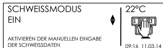
Wählen Sie mit den Pfeiltasten den Modus aus und bestätigen Sie die Auswahl mit START/OK (I) Taste, mit STOP/ESC (O) verlassen Sie das Menü.
