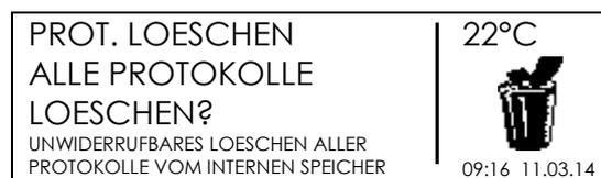
Betätigen Sie die Taste START/OK ( I ) um ALLE Protokolle zu löschen, STOP/ESC (O)Taste zum Verlassen des Menüs.
