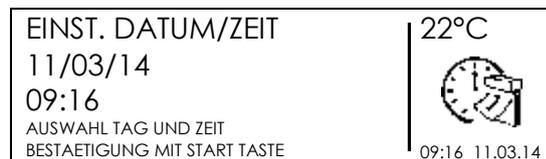
Mit den Pfeilen (▲)(▼) wählen Sie den entsprechenden Wert aus, mit (◀)(▶) bewegen Sie sich durch die Nummernfolge. Bestätigung mit START/OK (I) Taste, Abbruch mit STOP/ESC (O).
