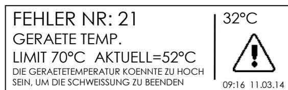
Da die Fittinge unterschiedlicher Hersteller, Grösse und Technologie verschiedene Charakteristiken aufweisen, überlässt das Gerät dem Anwender die Entscheidung ob er den Schweissvorgang startet oder nicht.
