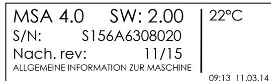
Verbinde das Elektroschweißgerät mit dem Netz oder mit dem bereits gestarteten Generator. Schalte das Gerät am Netzschalter ein. Am Display erscheint: Maschinentyp, Seriennummer, Software Version, Datum der nächsten Wartung.
