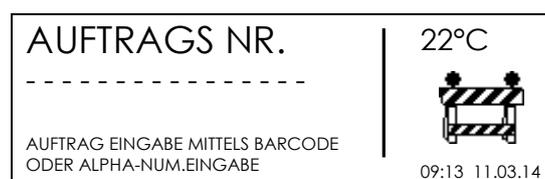
Die Eingabe erfolgt entweder durch Einlesen eines Barcodes (Code 128), wählen Sie es aus einer Liste der 5 zuletzt verwendeten aus, indem Sie die MENÜ-Taste drücken oder es manuell einfügen (max. 16 zeichen).
